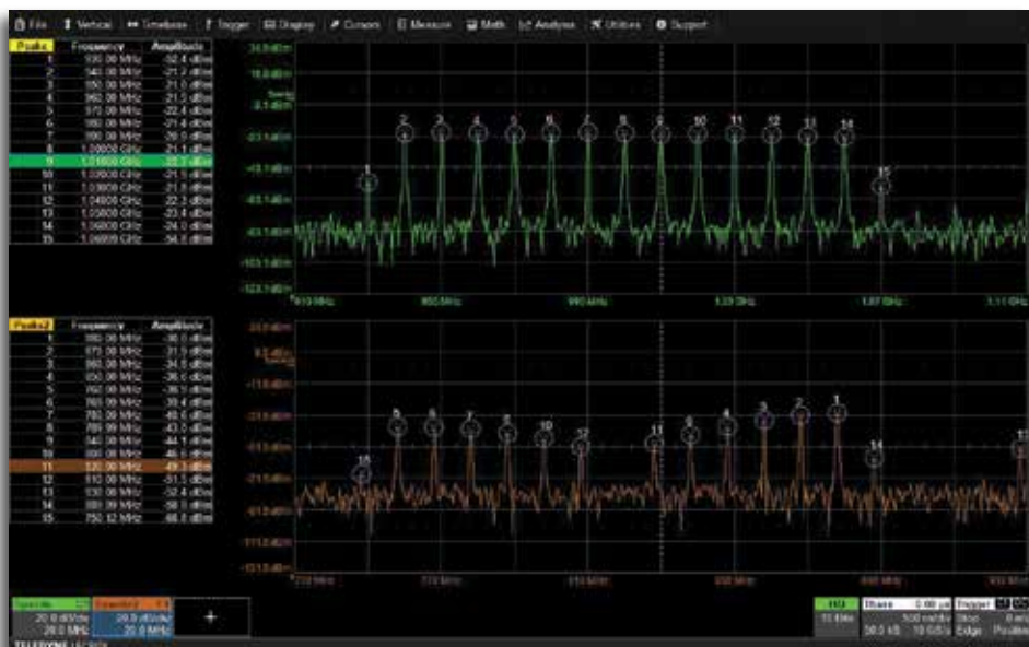
使用两个独立的输入和频率范围，进行高级频谱分析
